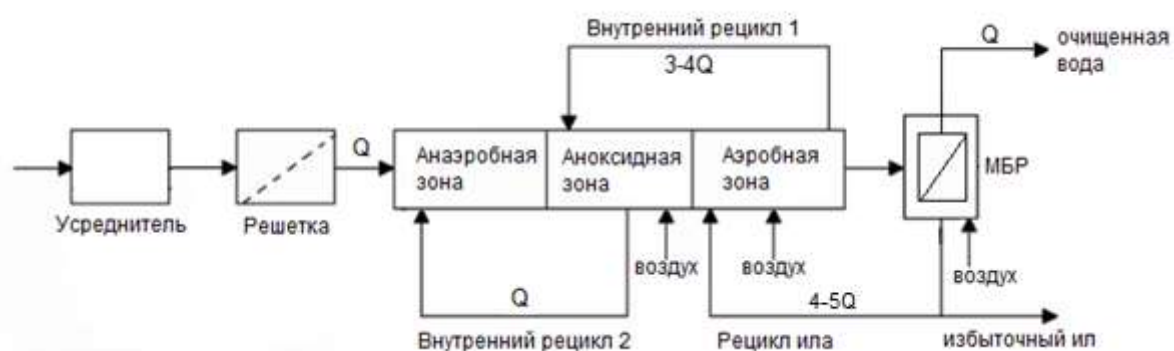
Рис. 1. Принципиальная схема биологической очистки сточных вод с использованием мембранной фильтрации.
